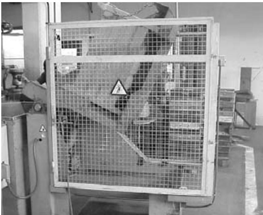
Son máquinas que sirven dos niveles predeterminados. Básicamente se trata de un portacontenedor que llevando un contenedor con piezas en su interior lo traslada entre ambos niveles y que al llegar a la parte superior descarga las piezas al realizar un giro manteniendo el contenedor unidos al mismo. La descarga puede ser a una tolva, a una mesa o al interior de una máquina.
